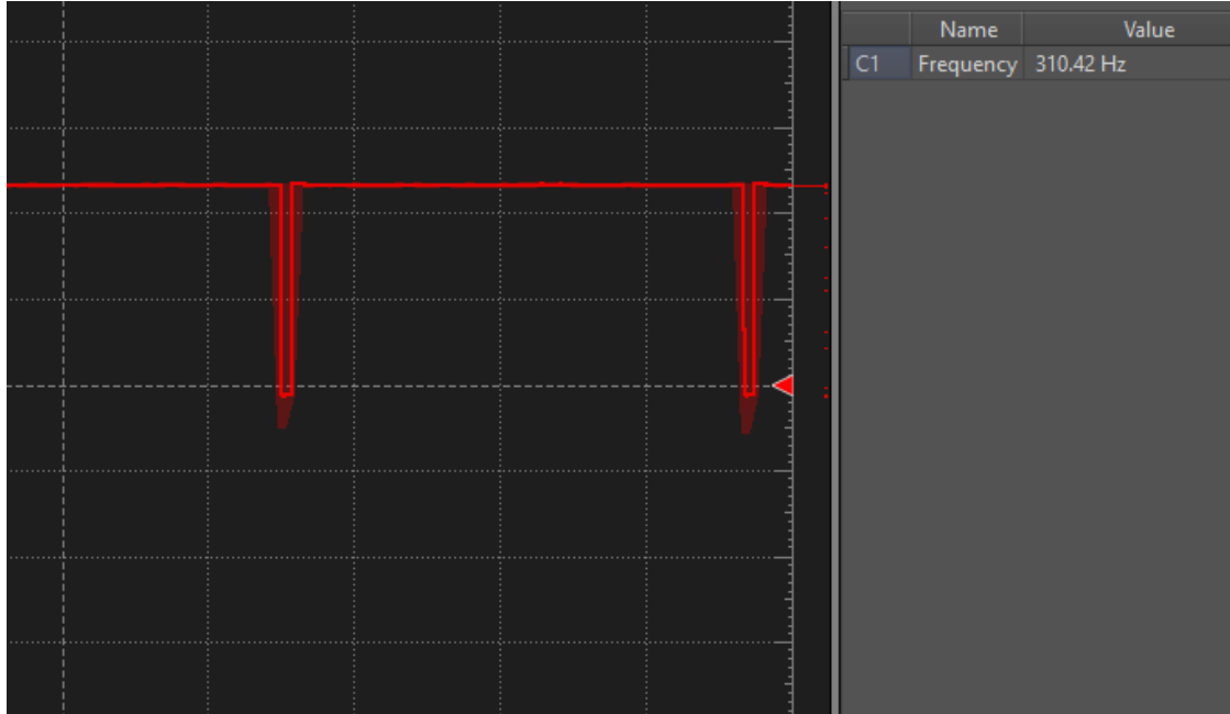
Şekil 17.3 Foto diyot üzerinde ışık miktarı azken 555 entegresinin çıkış sinyali
